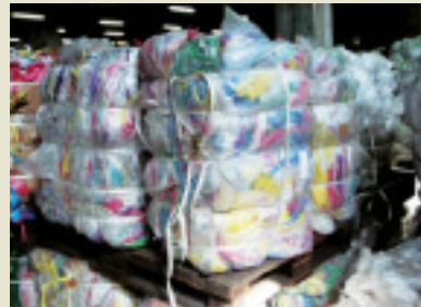
圧縮された廃棄プラスチックブロック 廃棄プラスチックを圧縮機で圧縮し、ブロック単位でICタグを貼付する。
