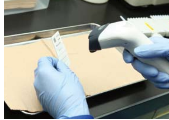
2次元バーコードでデータを管理し、 確実に迅速な測定が行われる。
